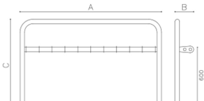
Aparcapatinetes formado por estructura en U con cantos redondeados y tubo intermedio longitudinal fabricado a partir de tubo de  $\varnothing$  48 mm y aros que permiten aparcar los patinetes y bloquearlos con candado o pitón.
